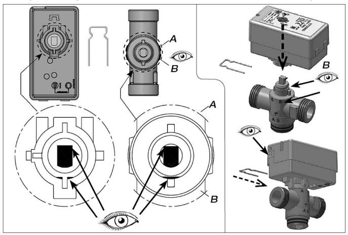
Подключение электрического кабеля производится только после установки привода на шток клапана.
