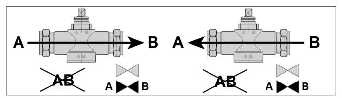
Трехходовые клапаны обеспечивают проход перемещаемой среды – между нижним патрубком и одним из боковых (как на слияние потоков, так и на разделение) в зависимости от положения золотника.
